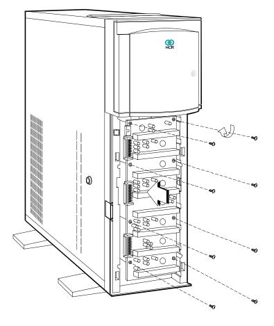
Figure D-9. Installing the Hot Plug Backplane
